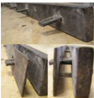
17 : Exemple de barlotières avec pannetons et feuillard.
